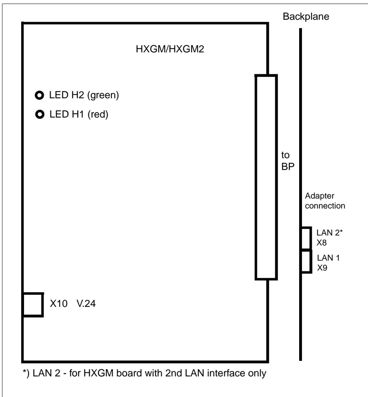
Figure 2-3 HXGM interfaces (S30810-Q2930/Q2940-X/X100)
